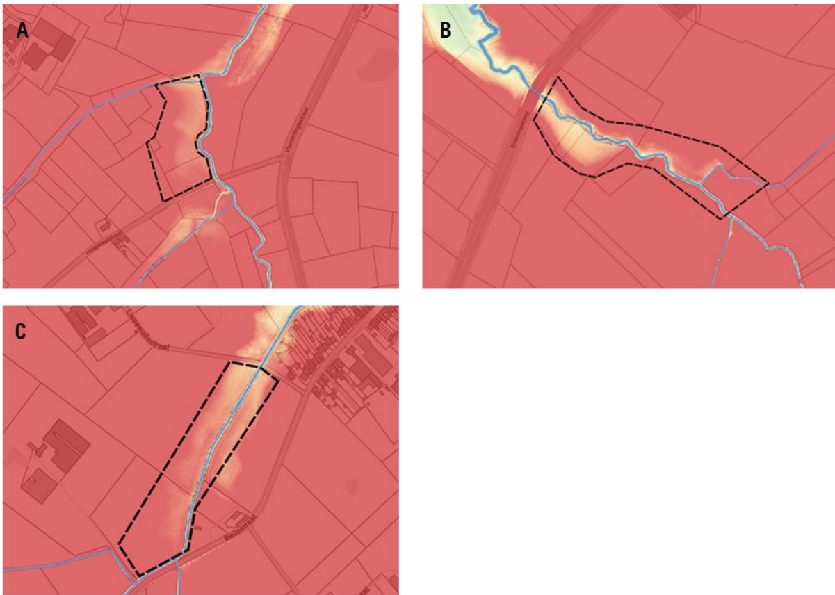
Figuur 48. Voorbeeldlocaties de voorbuffers (elk \pm 40.000 \text{ m}^3 ) van Scenario II (3 spaarbekkens van elk \pm 500.000 \text{ m}^3 ). Ter hoogte van (A) Elverdinge, (B) Poperinge en (C) Vlamertinge.
